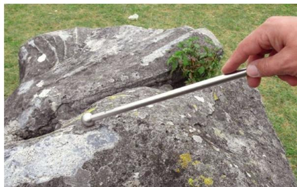
Detektion von Hohlstellen mit dem Kugelstab
