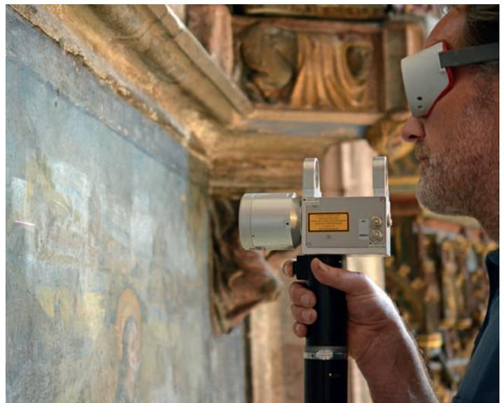
Dipl.-Rest. Fabian Schorer bei der Ausführung der Reinigungsversuche mittels Laser (Foto: BLfD, Nadia Thalguter, 2018)
