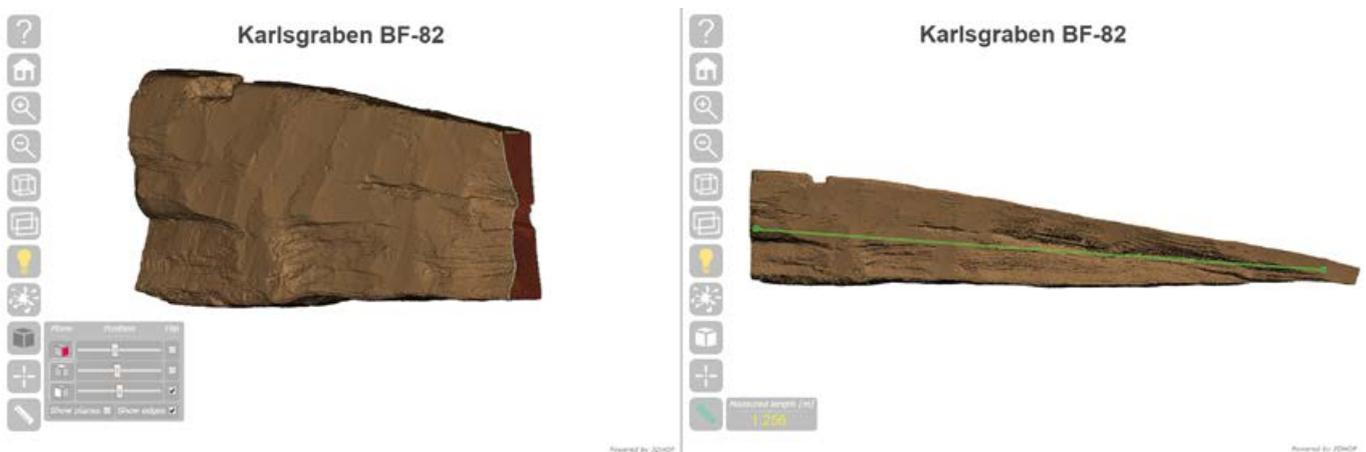
Anwendung weiterer Werkzeuge des Web-Viewers auf die 3D-Daten der Holzobjekte: Schnittfunktion (links); 3D-Messfunktion (rechts)
