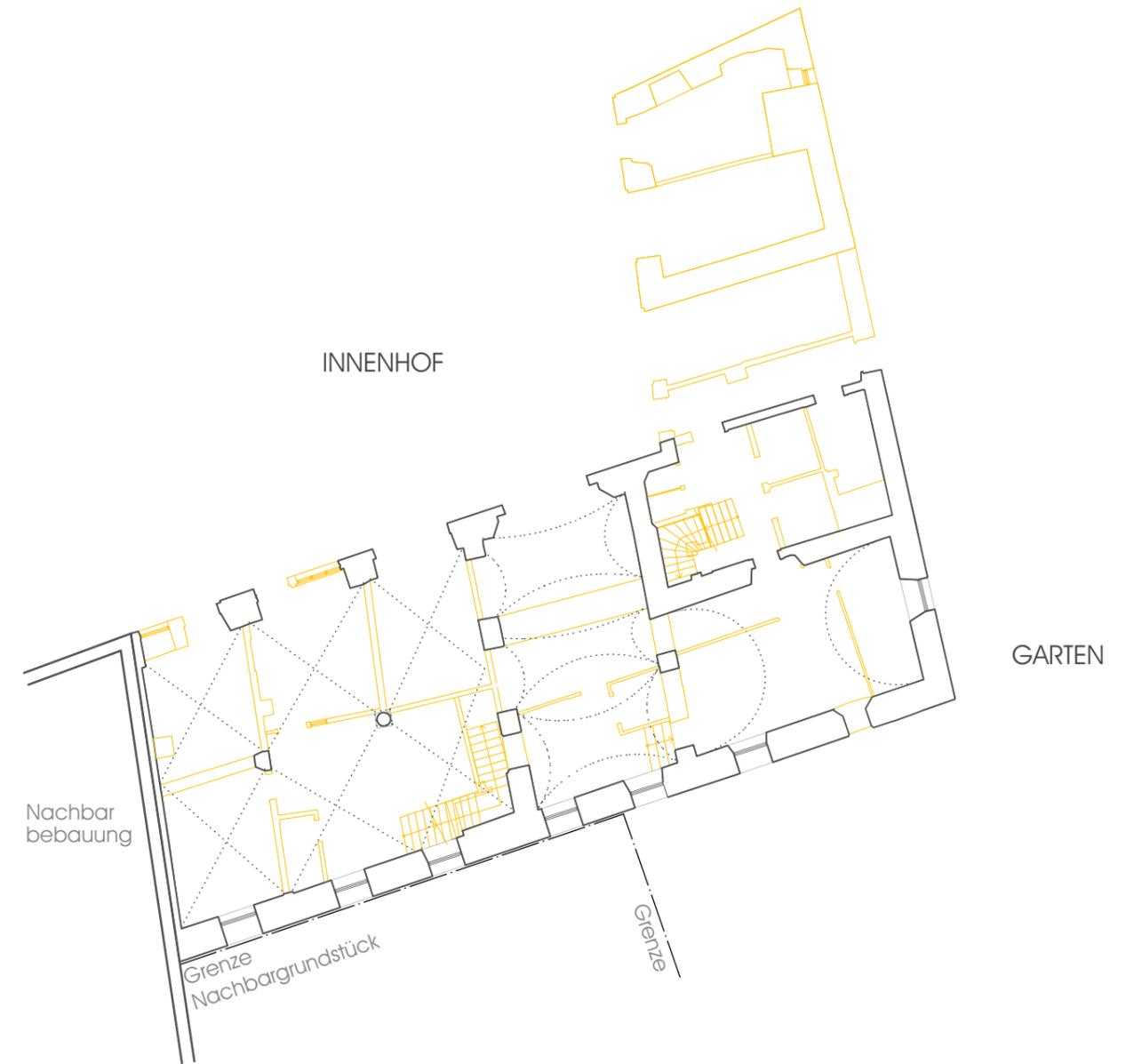
Abb. 48 Hinterhofremise, mögliche Rückbaumaßnahmen, Erdgeschoss M 1.200
