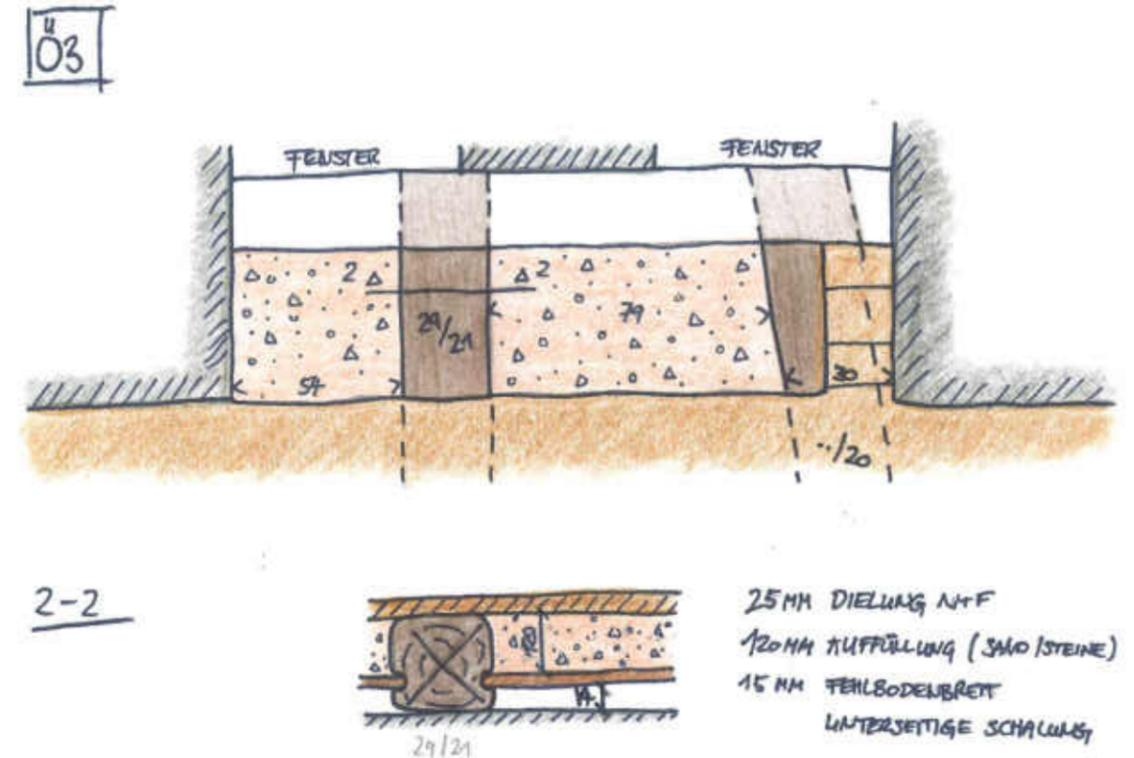
Abb. 18 Bauteilöffnung der Deckenbalkenaufleger, Decke 1.OG - 2.OG
