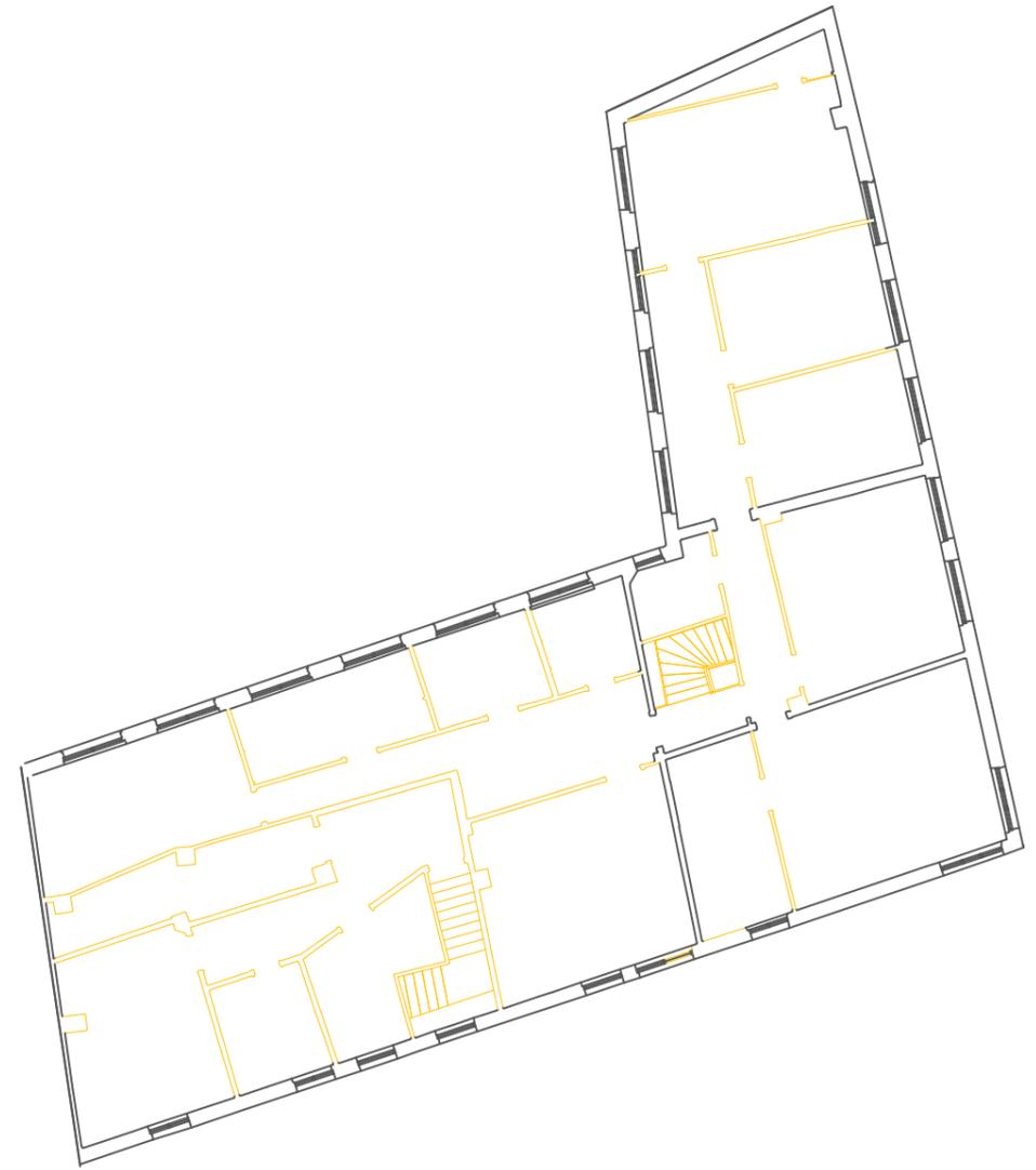
Abb. 50 Hinterhofremise, mögliche Rückbaumaßnahmen, 1. Obergeschoss M 1.200
