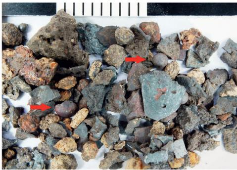
In der Sedimentprobe sind hohlkugelförmige Partikel mit kreisförmigen Öffnungen auffällig, welche als Ausgasungsporen interpretiert werden können. Beim Eisenverhütten oder Schmiedeschweißen entstehen durch Hammerschläge und dem damit einhergehenden Herauspressen und Erstarren des „flüssigen“ Eisens kugelförmige Metallpartikel.
