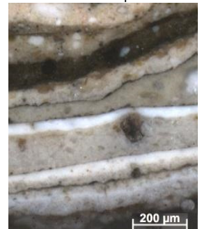
Fassungsaufbau mit mehrschichtiger Erstfassung im Anschliff
