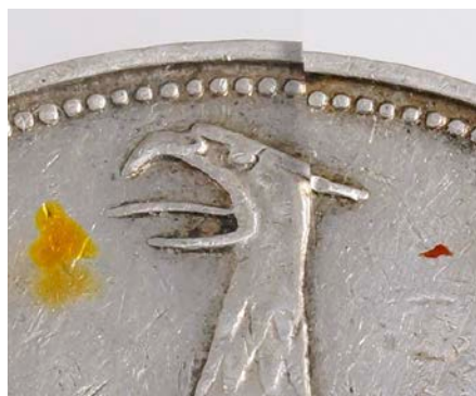
Makroaufnahme: Die linke Münzseite ist mit einer Glasscheibe abgedeckt (daher die „Stufe“ am oberen Rand). Zu sehen ist hier die gelbe Farbe der unveränderten Reagenslösung. Auf der rechten Bildseite ist hingegen das Ergebnis der Nachweisreaktion erkennbar. Der kleine, rote Fleck auf der freiliegenden rechten Münzseite ist klares Indiz für das Vorliegen von Silber. Die Länge des Messflecks beträgt knapp 0,5 mm. Man könnte die Reaktion auch unter dem Mikroskop in noch stärkerer Miniaturisierung ausführen.
