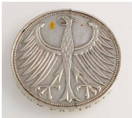
Demonstration eines Silbernachweises mittels einfacher Tüpfelreaktion am „Heiermann“, der heiß geliebten, klassischen 5 DM-Münze aus vergangener Zeit (diese Münze besteht aus Silber mit einem Feingehalt von 625, d. h. 62,5% Silber).
