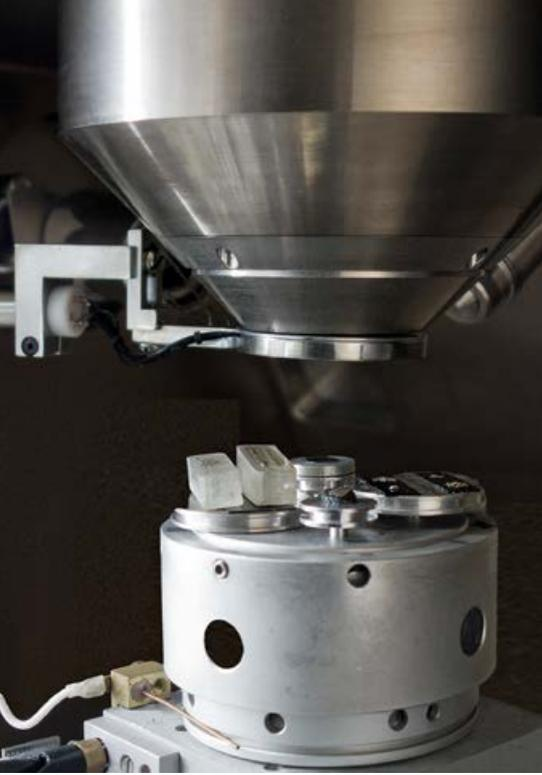
Blick auf den befüllten Probenstisch in der Vakuumkammer des Rasterelektronenmikroskopes (Foto: BLfD Zentrallabor, Christian Gruber)
