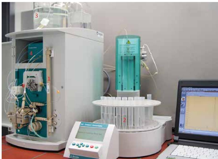
Ionenchromatographie im Zentrallabor. Mittig befindet sich der Probenwechsler, links der eigentliche Ionenchromatograph. Die wichtigsten Komponenten sind bezeichnet und in die schematische Abbildung auf der nächsten Seite übertragen (Foto: BLfD, Zentrallabor)
