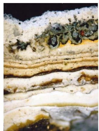
Anschliff in 100-facher Vergrößerung, Schichtenabfolge
