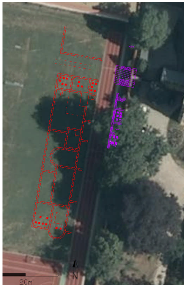
Orthofoto des Sportplatzes des Albrecht-Aldorfer-Gymnasiums; überlagert mit der Interpretation der Bodenradarmessung (rot) und des Grabungsplanes von 2007 (violett). Der Aufbau der Thermenanlage lässt sich daraus deutlich ablesen. Foto & Grafik: BLfD
