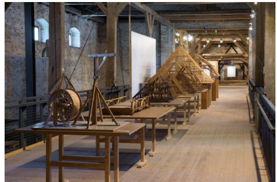
Modelle von Dachtragwerken im Bauarchiv Thierhaupten. (Foto: BLfD/Michael Forstner)
